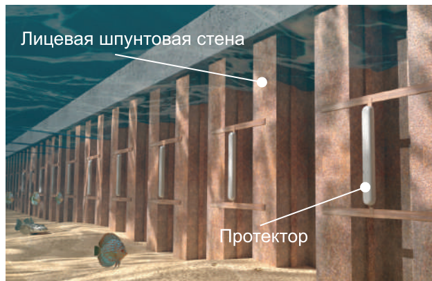
Протекторы установленные на причальном сооружении
