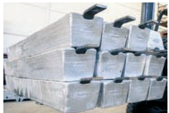
Перевозка цинковых протекторов после производства на склад для проведения контроля качества
